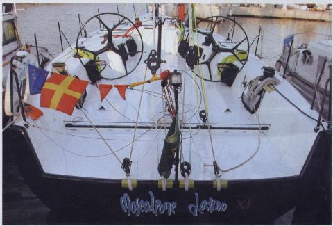
Dall'alto, in senso orario; la tuga con le manovre al minimo: solo quattro stopper. Il piano di coperta visto da prua. *Mascalzone* visto da poppa, da notare l'estrema "semplicità" del pozzetto. La ruota del timone in carbonio, con la tastiera per il controllo della randa. Le rotaie per i genoa e le lande in acciaio. La serie dei ripetitori dei dati mare e vento, la prua e il coffee grinder.
